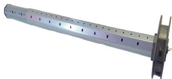
Teleskopwelle 60 mm Achtkantwelle mit Walzenkappe, Teleskop und schiebbare Gurtscheibe inkl Lager, Gurtscheibe und Walzkappe vormontiert Art.-Nr. 60 100
